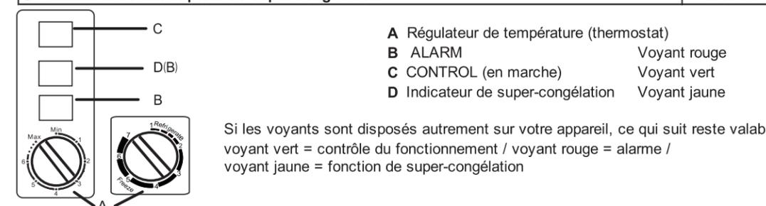
**4ème version avec le commutateur séparé pour la fonction SUPERBE de GEL** **FIG. 4d**
