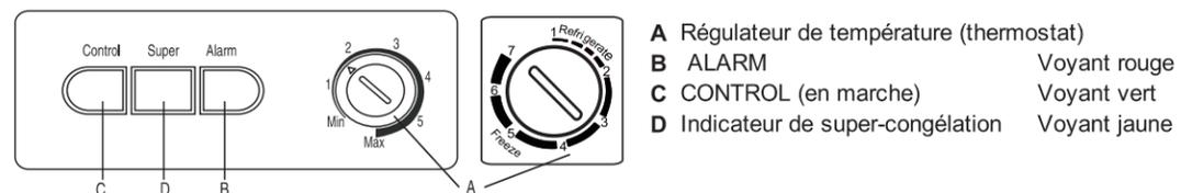
**2e variante avec interrupteur séparé pour fonction super-congélation** **FIG. 4b**
