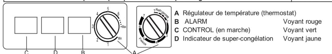
**3 variante avec interrupteur de super-congélation** **FIG. 4c**
